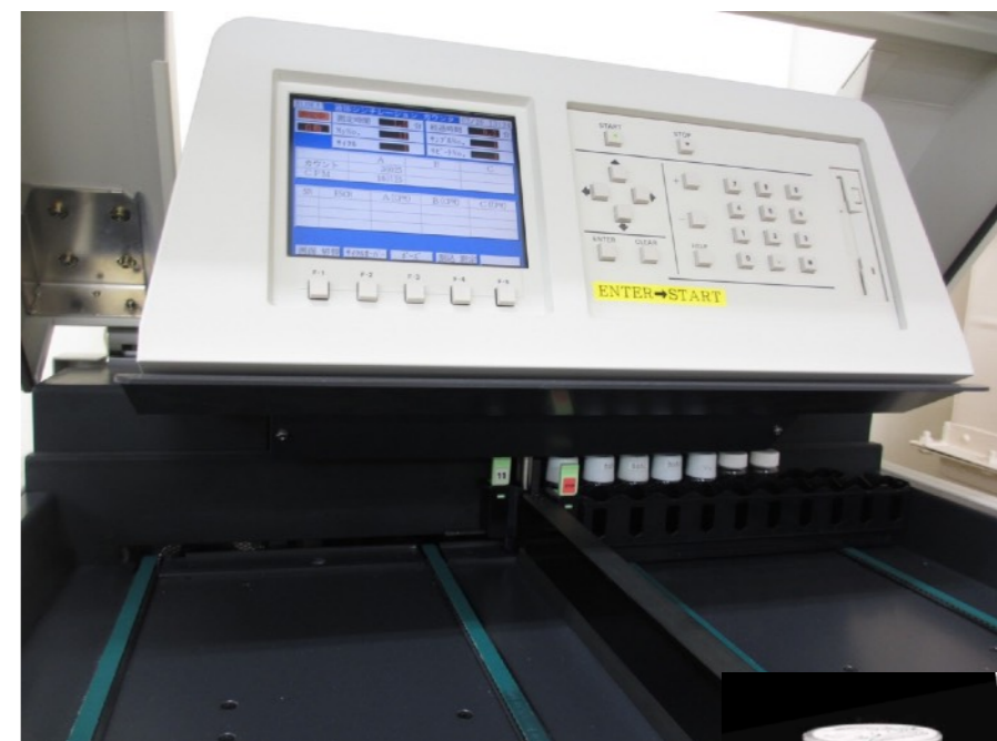
液体シンチレーション カウンタ
