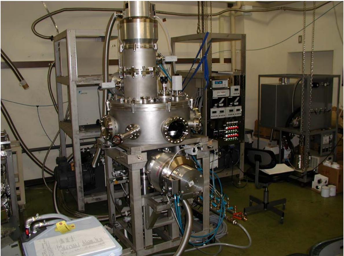
図 2.5 ガスジェットチェンバーの写真図
