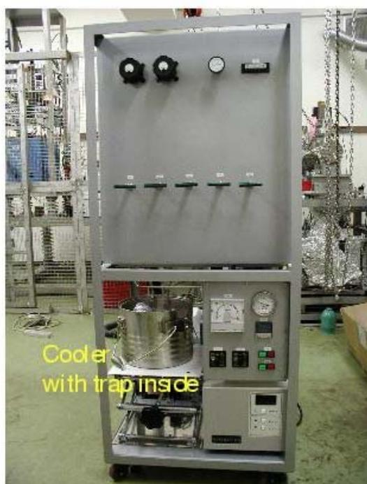
図 2.7-2 ガス循環装置の写真
