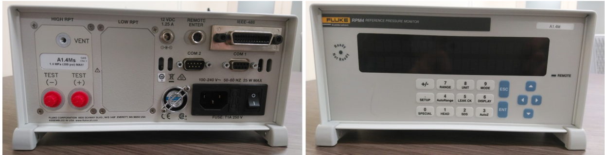
Fig.6.7 圧力計 RPM4。背面 (左図), 前面 (右図)。
