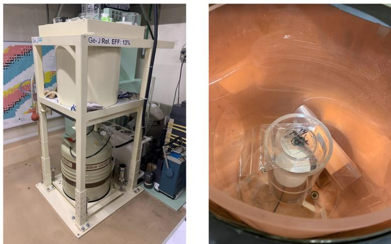
図 28 Ge 検出器 (左図) と測定中の基板の様子 (右図)。
