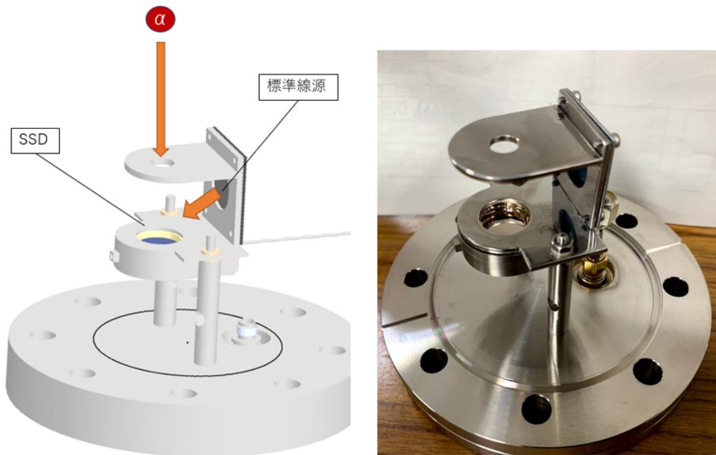
図 12 Fr 測定装置の 3D 図と製作・組み立て後の様子。
