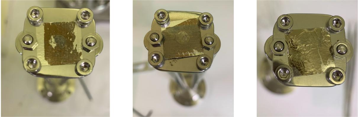
図 62 順に 14、27、50 nm の炭素膜を被せた基板
