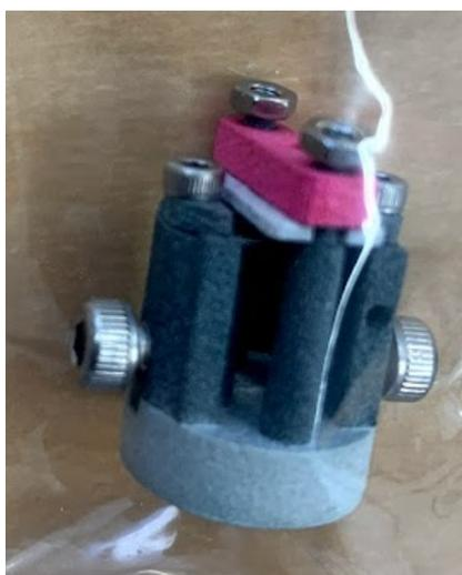
図 70 低エネルギー  $^{221}\text{Fr}$  発生装置の試作品。
