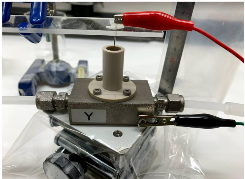
図 40 使用したチラー（左図）とチラーの設定温度 10 °C で電着したときの電着セル（右図）。電着セルの周りには水滴が見られた。
