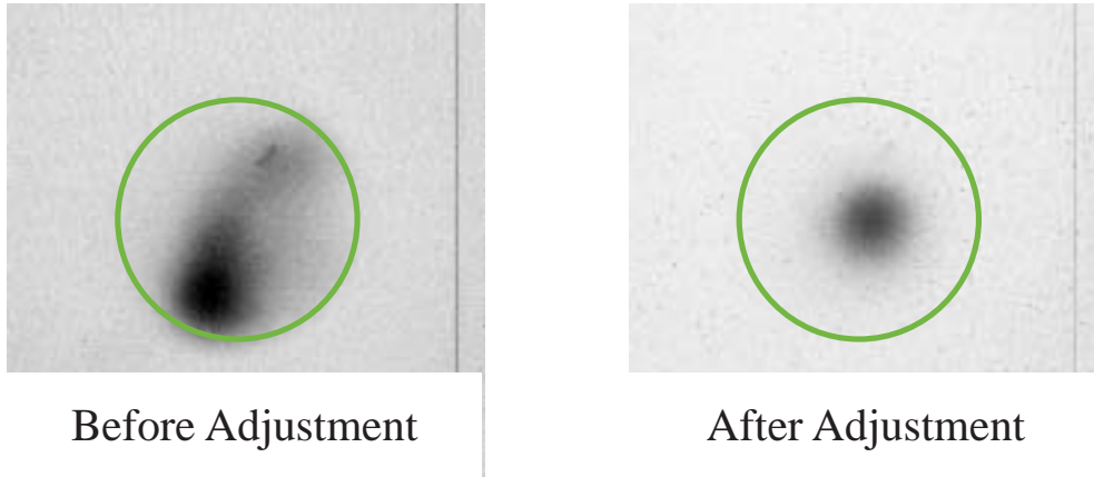
図 5.6: 軸あわせ前後でのプラズマ径の変化
