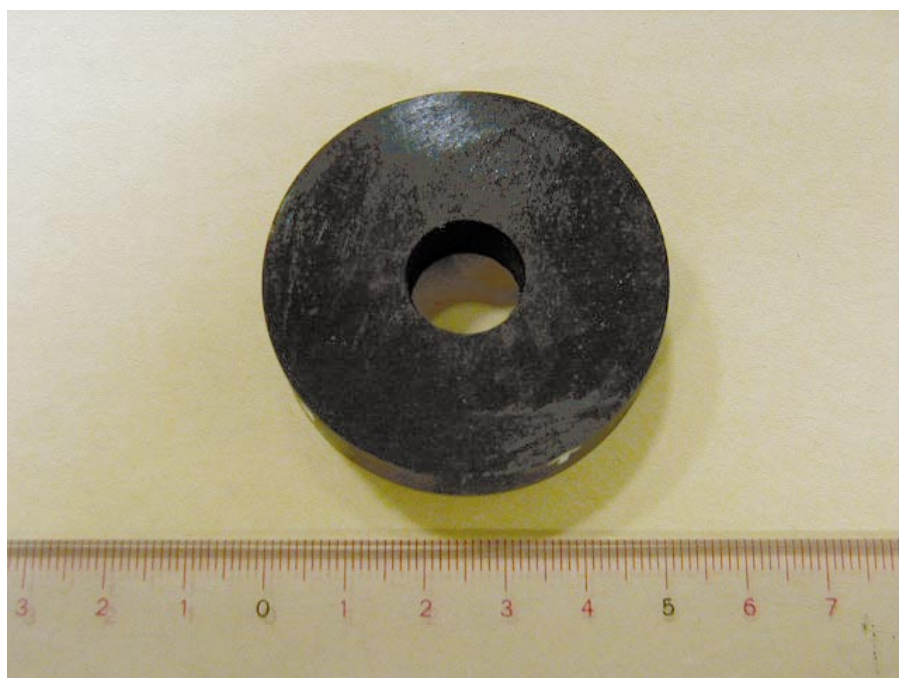
図 3.14: 装置に使用するイットリウム系高温超伝導バルク材
