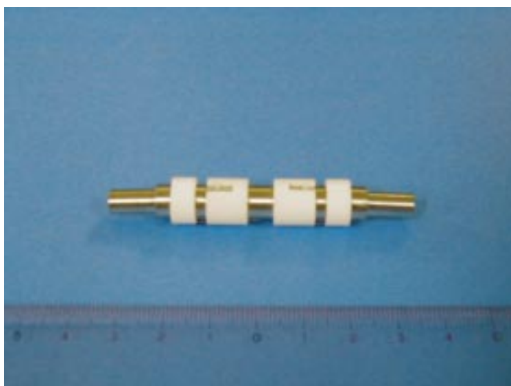
図 3.9: ドリフトチューブ（全長 7 cm、内径 3 mm）
