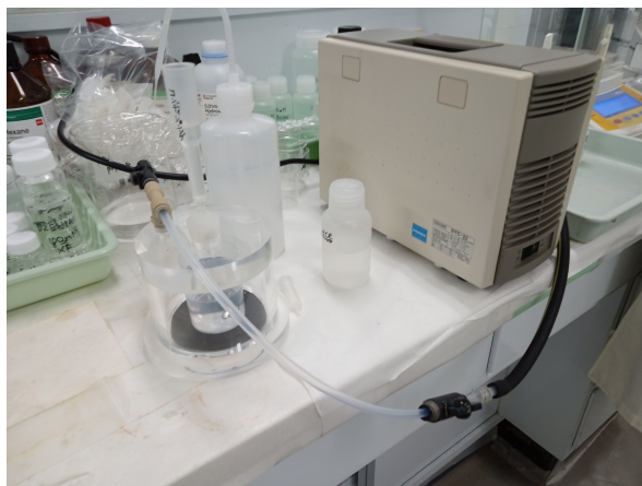
図 3.7: Ra の分離に用いる実験装置。写真左の亚克力容器内には溶液を受けるビーカーが設置され、蓋についたゴム栓の中に DGA レジンカートリッジが取り付けられている。亚克力容器内は写真右側の真空ポンプで減圧される。この写真は分離作業前のコンディショニング時に撮影されたものであり、分離を行う際は亚克力容器を図 3.3 の Rn 回収装置に入れて実施する。
