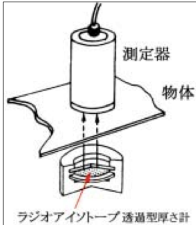
図 8.9.1 厚み計の原理
