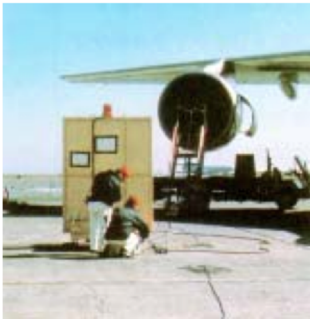
写真 8.9.2 ジェット機エンジンの非破壊検査
