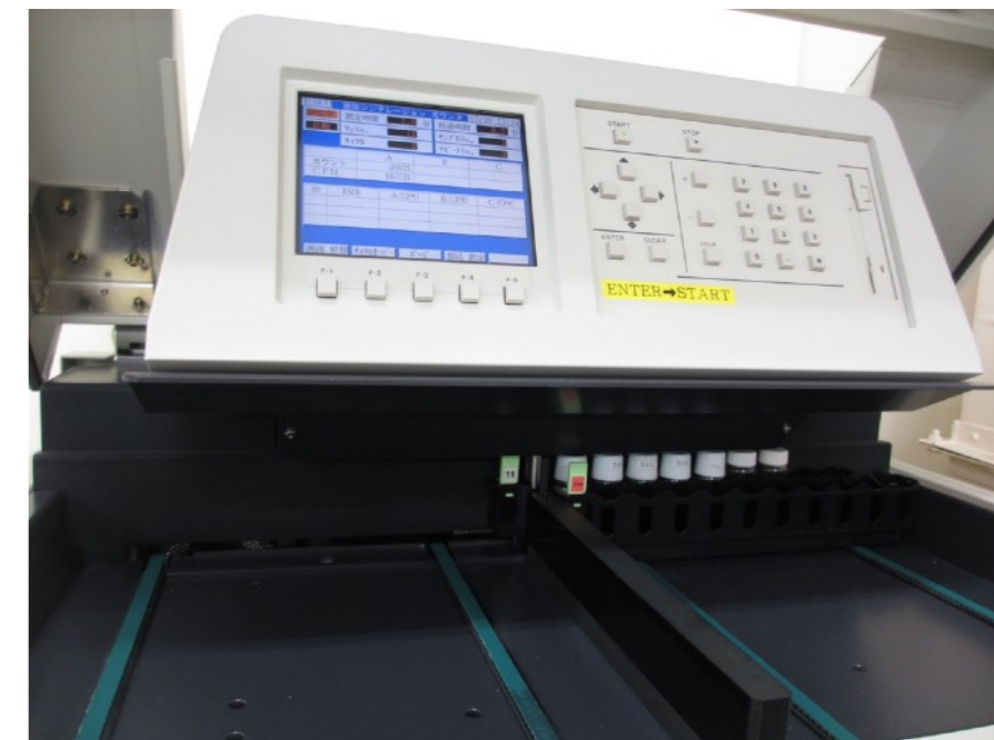
液体シンチレーションカウンタ
