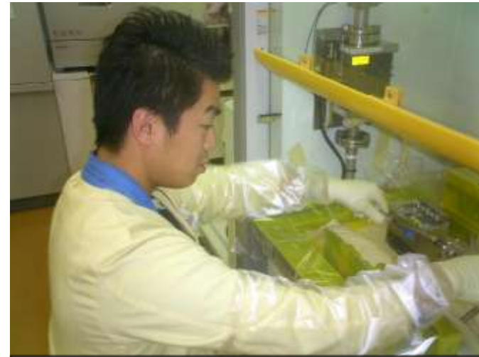
原子炉に入れた試料を取り出している様子。(放射化分析法)
