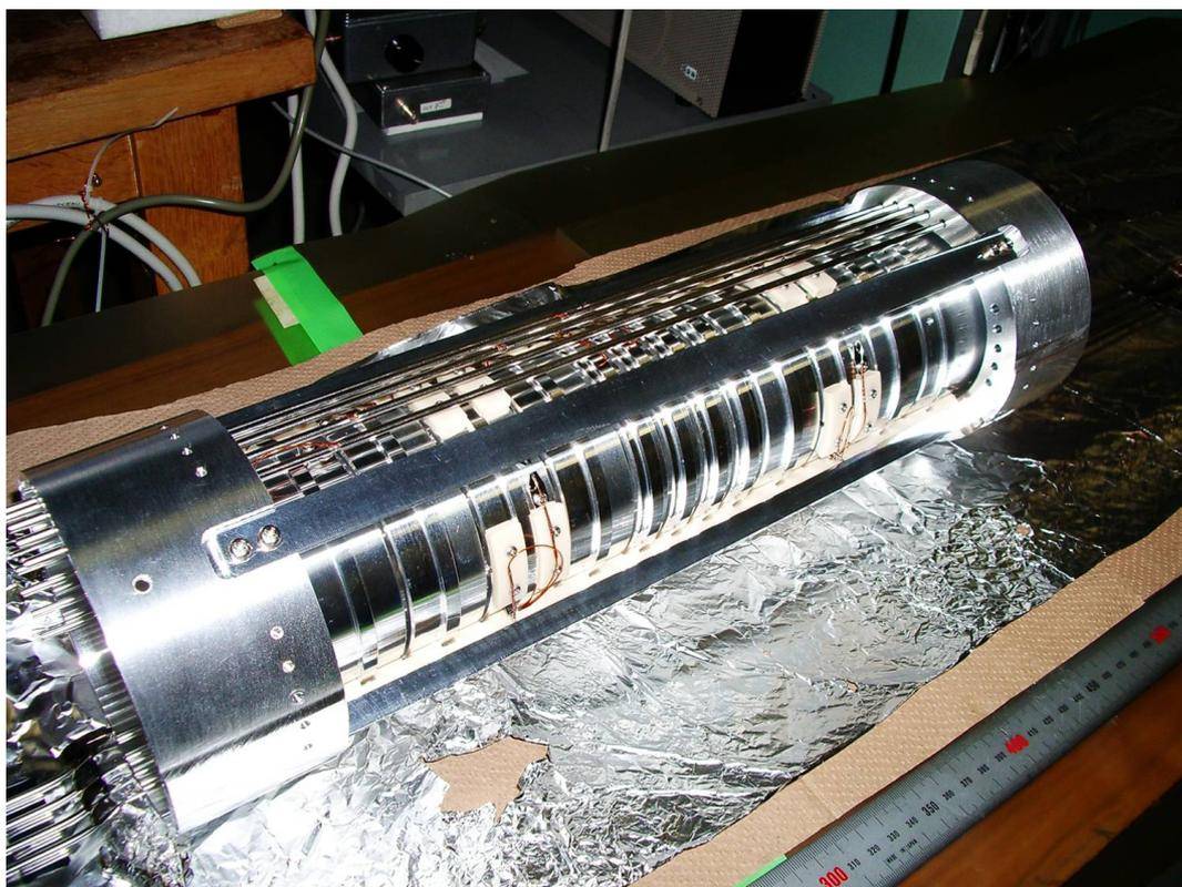
図 4.5: warm bore 用の multi ring 電極
