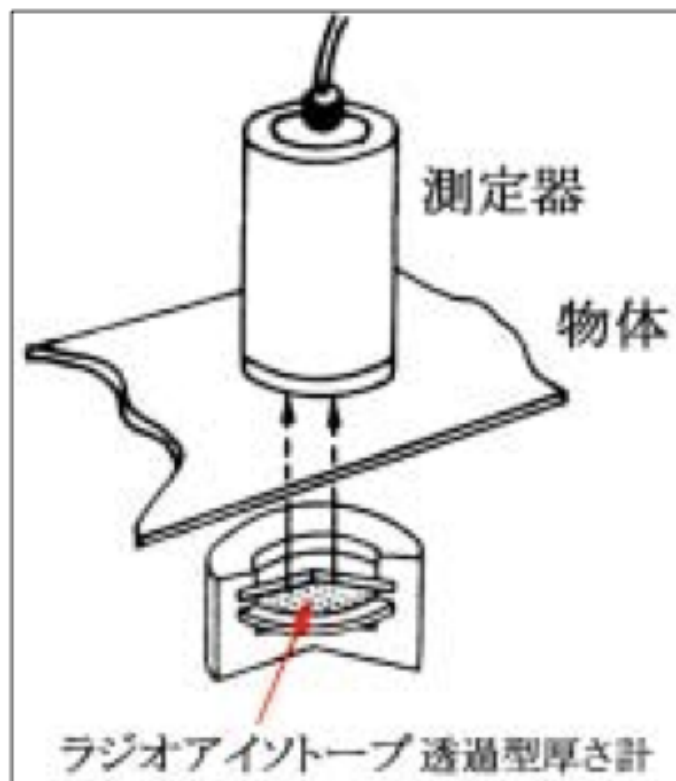
図 8.9.1 厚み計の原理
