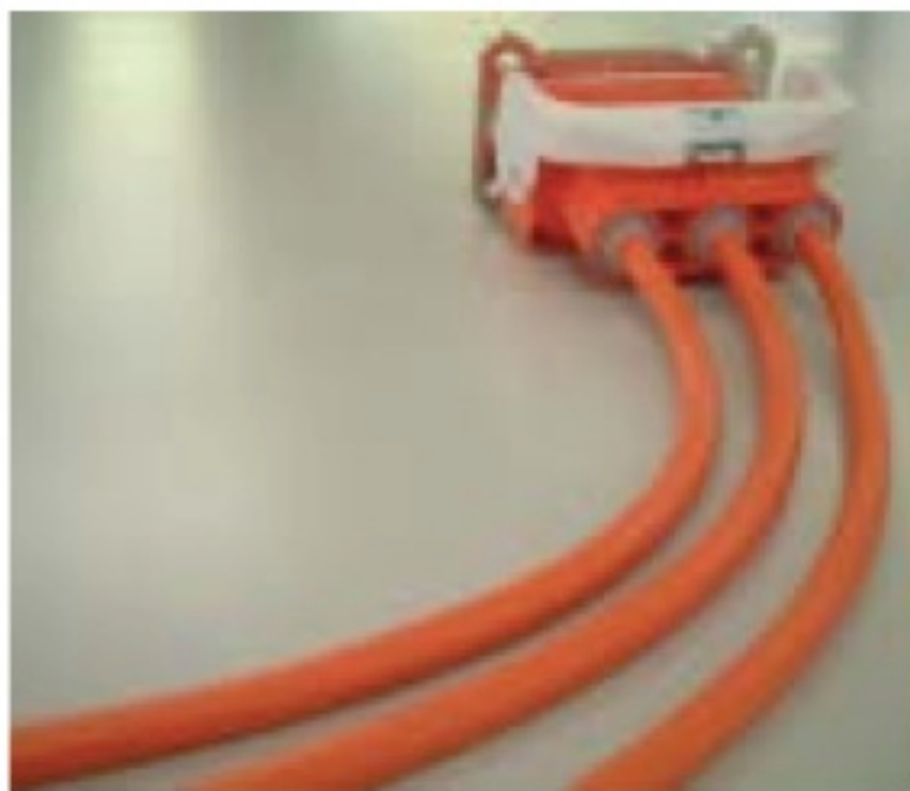
写真 8.7.2 ハロゲンフリー（燃えても有害なハロゲンガスが発生しない）絶縁体を使った高圧回路ケーブル
