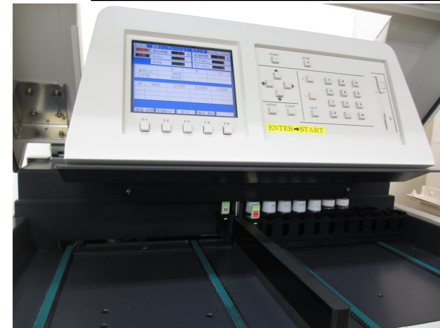
液体シンチレーションカウンタ
