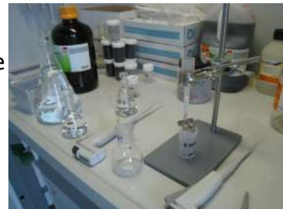
イオン交換樹脂による<sup>90</sup>Sr分離精製
