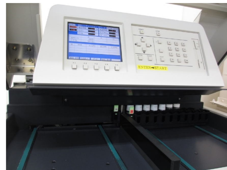
液体シンチレーションカウンタ
