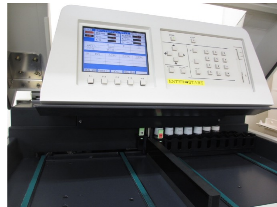
液体シンチレーションカウンタ
