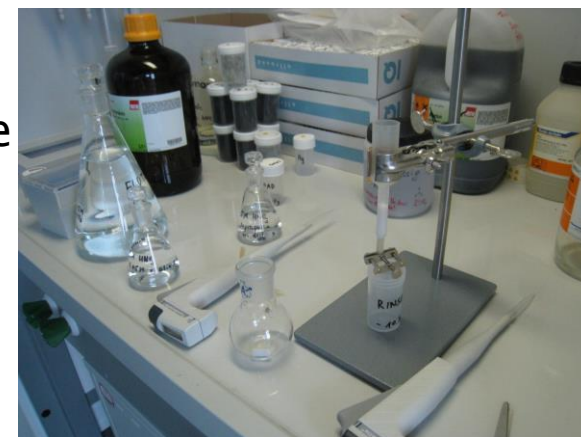
イオン交換樹脂による ^{90}\text{Sr} 分離精製
